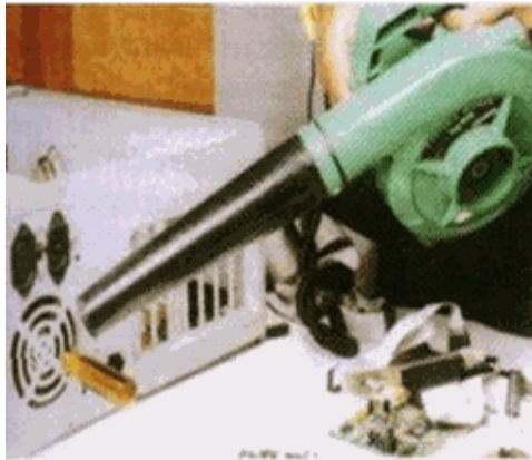
Limpeza de la fuente con soplador o blower
