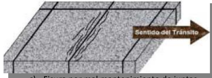
c) Fisura por mal mantenimiento de juntas.
