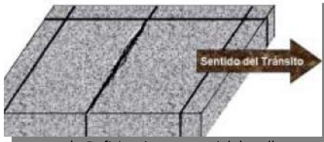
a) Deficiencia en material de sello.
