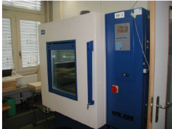
Figura 2. Cámara de climatizado.
