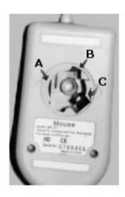
La limpieza de los rodillos se puede hacer con un copito humedecido en alcohol isopropílico. Si la suciedad está muy dura o adherida a los rodillos, se puede remover con una cuchilla o un destornillador pequeño teniendo mucho cuidado de no rayar o desalinear dichos rodillos.
