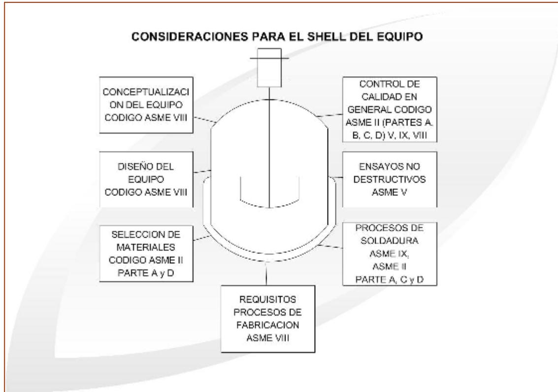
Según lo indicado en la figura, se puede apreciar las secciones del código ASME aplicable a los diversos procesos hasta completar el alcance del proyecto del equipo.
