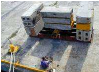
Figura 4. Pruebas de Carga Puerto del Mariel. Base de almacenamiento REPSOL-YPF.
