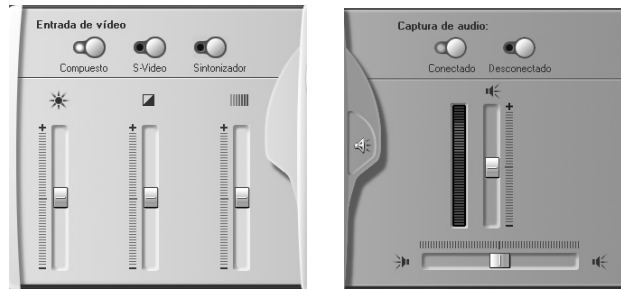
Paneles de video (izquierda) y audio (derecha) para ajustar los niveles durante la captura analógica.
