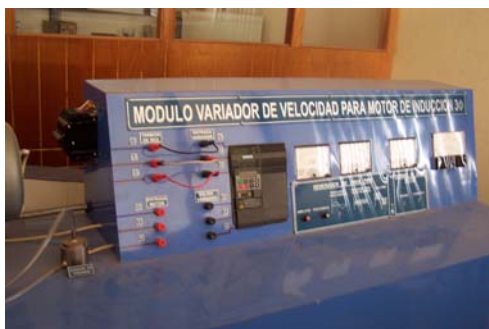
Fig. 10 Fotografía del variador de Velocidad
