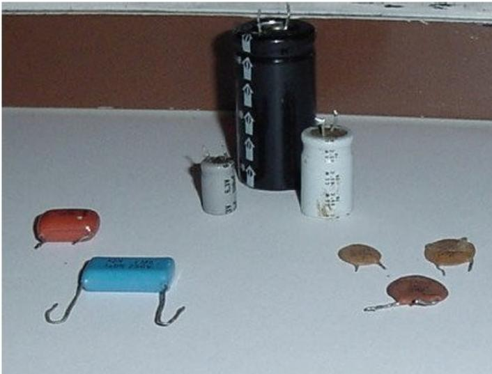
Un capacitor consta de dos partes principales. La primera es un par de placas metálicas. Estas placas metálicas se encuentran separadas unas fracciones de milímetro, y cada una va conectada a una terminal diferente del circuito (o sea, una placa es positiva y otra negativa). Entre estas dos placas hay un material no conductor, que se llama dieléctrico. El dieléctrico evita el paso de corriente entre una placa y otra.
