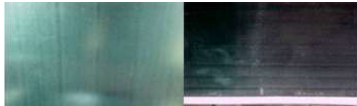
Figura 18. MANCHAS DE ACEITE LAMINADO
