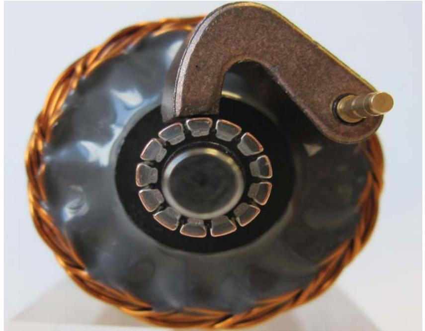
*Conjunto escobilla-colector o conmutador, necesario para que el motor DC gire. El colector de 13 delgas facilita la regulación y prolonga la vida en servicio del motor de corriente continua.*
