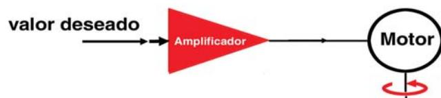
En la figura de arriba, esquema de bucle abierto. Abajo, bucle cerrado
