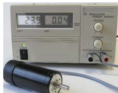
*Fuente de alimentación dc de laboratorio. El voltaje se puede regular de 0 a 30 V y la corriente de 0 a 3 A*
