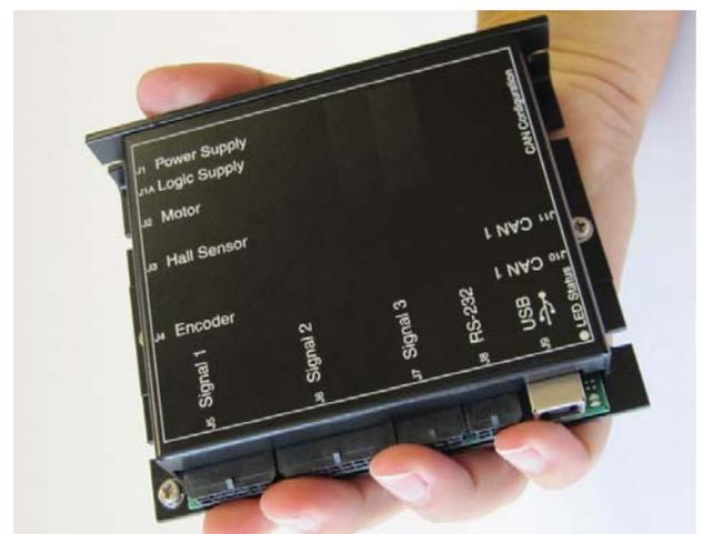
Electrónica de control de velocidad, par y posición para motores DC y brushless DC.
