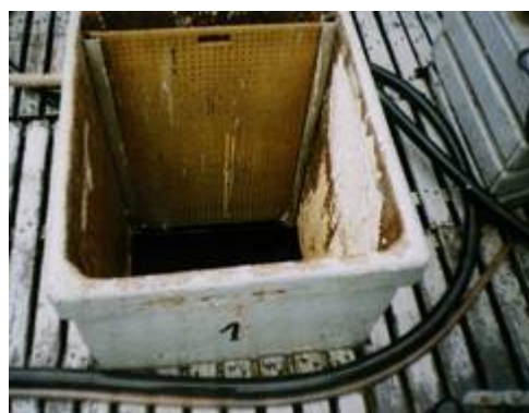
Figuras 5 e 6. Viveiro de água circulante das embarcações atuneiras. (Tina).
