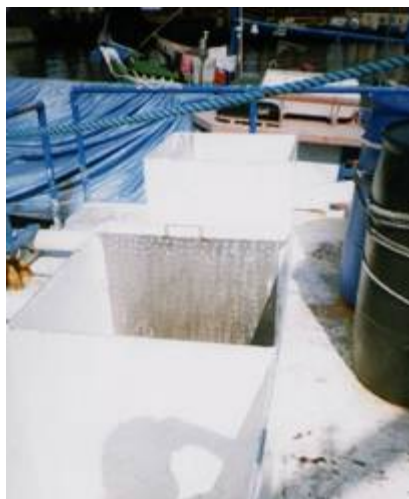
Figuras 5 e 6. Viveiro de água circulante das embarcações atuneiras. (Tina).
