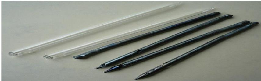
Figura 16: Amostradores e amostra retirada do aço líquido
