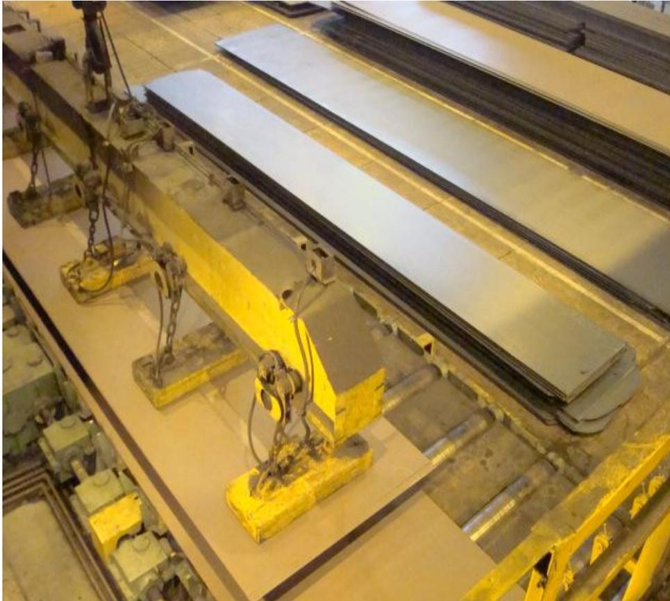
Figura 25: Ponte rolante retirando e colocando chapas do empilhamento
