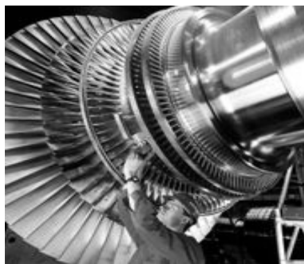
Rotor de una turbina de vapor producida por Siemens, Alemania.
