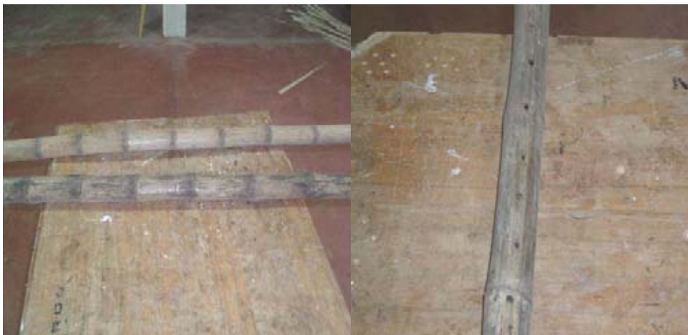
Figura 11: Culmos con exceso de curvatura y culmo atacado por insectos
