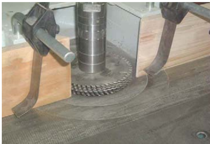
Figura 6: Múltiples montadas en máquina Tupí.
