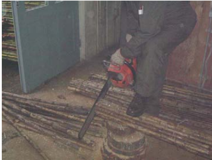
Figura 1: Dimensionamiento de las piezas de 4m.
