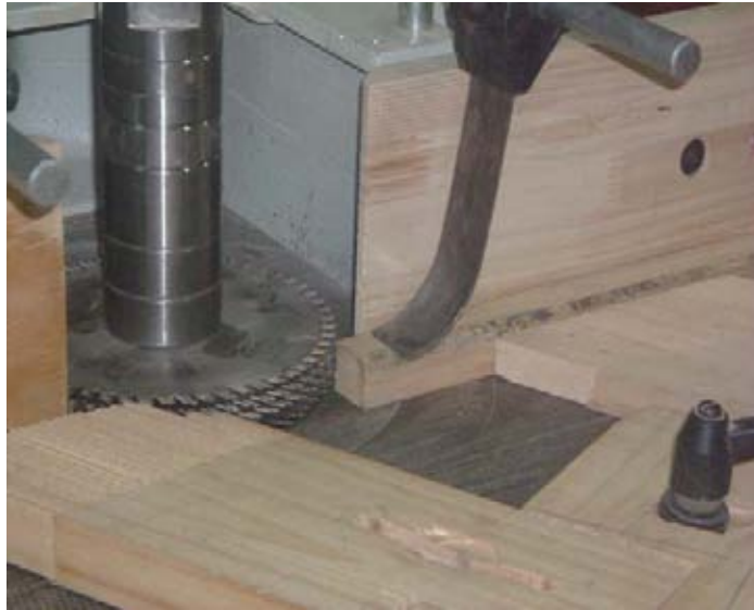
Figura 5: Baza posicionada en la máquina tupí.
