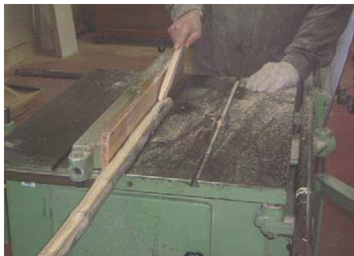
Figura 4: Formación de basa con el uso de sierra circular.
