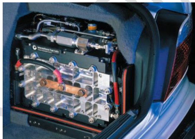
Fig. N° 24: Vista de la ubicación de la célula de combustible en la parte posterior del vehículo
