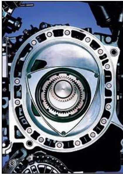
Fig. Nº 5: Vista de un motor tipo Wankel
