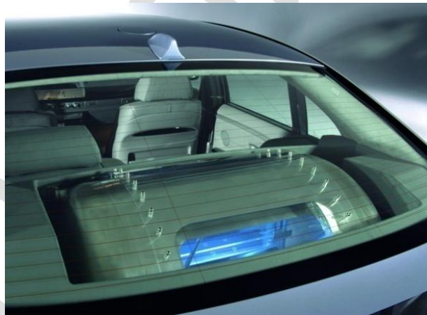
Fig. N°19: Vista del la ubicación del tanque criogénico en el BMW Hydrogen7
