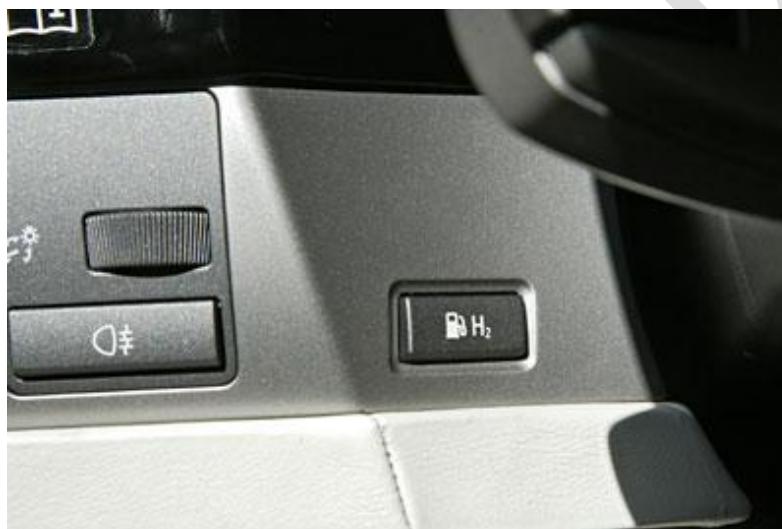
Fig. Nº 16: Vista del comando de cambio de combustible en el panel de control del vehículo
