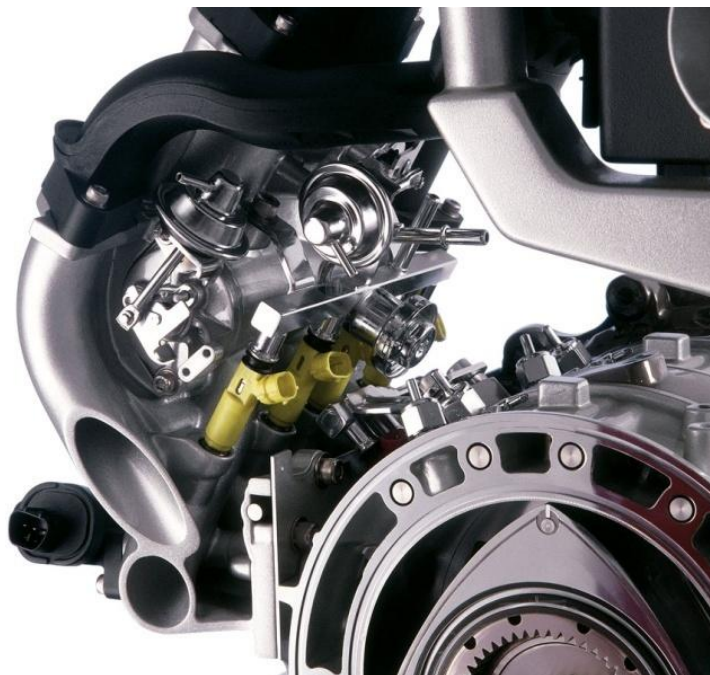
Fig. N° 34: Vista del colector de admisión de aire y de los inyectores de gasolina.
