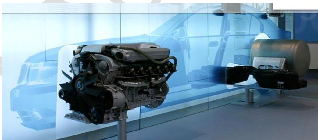
Fig. Nº 15: Vista del motor de BMW serie 7 a hidrogeno y su depósito de combustible presentada en el Museo Alemán
