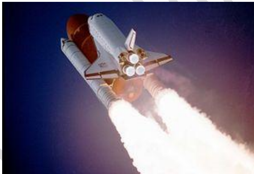
Fig.1: Diferencia de las llamas entre los impulsores y los motores principales de las lanzaderas espaciales.
