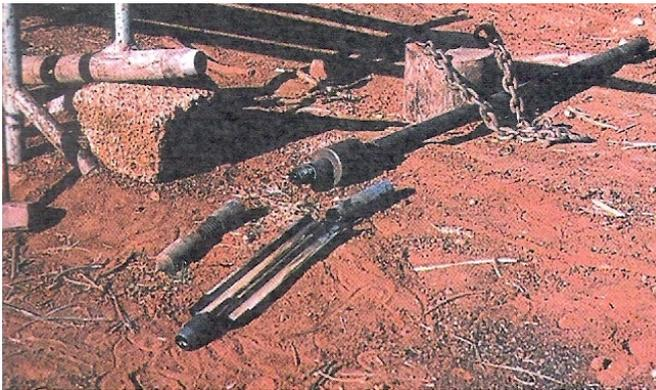
**Foto No 2.** TOMAMUESTRAS, PUNTAZAS Y ELEMENTOS DEL ENSAYO SPT. Fuente: Vallejos (2002)
