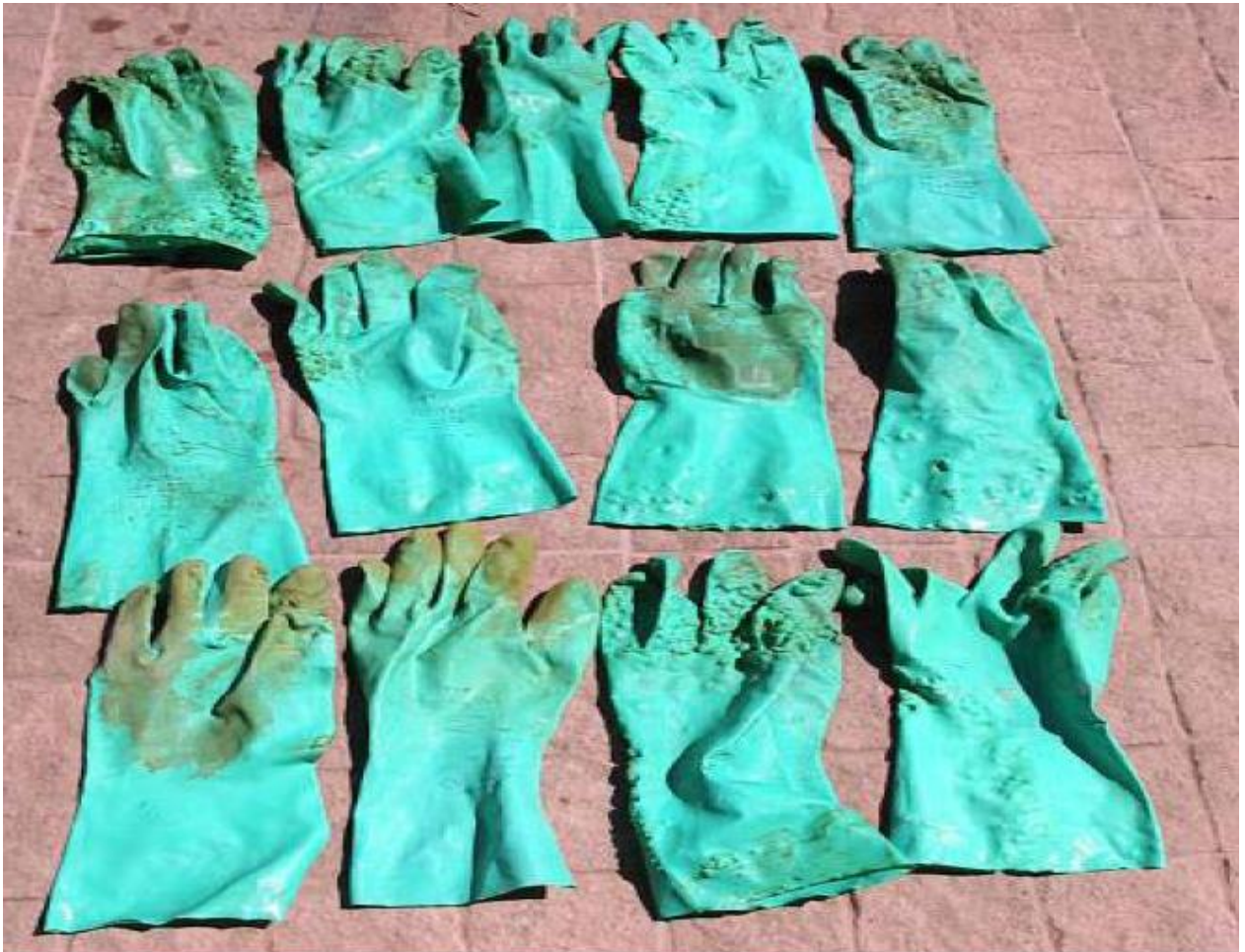
Estado De Deterioro De Los GUANTES , Debido A La Manipulación De Químicos
