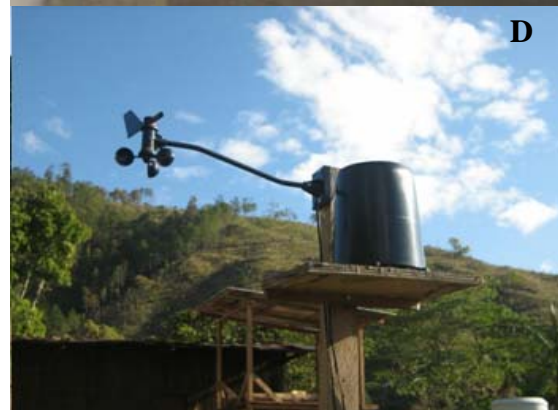
Foto No 17. A - Finca Mery y Felipe en Cerro El Volcán. B - Computador y accesorios para obtención de datos instrumentales. C - Unidad Sísmica SARA SR 04. D - Sensor de dirección y velocidad del viento. Cortesía de Ineter.
