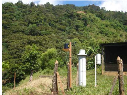
Foto No 6. Pluviómetro y sus accesorios Foto T. Obando
