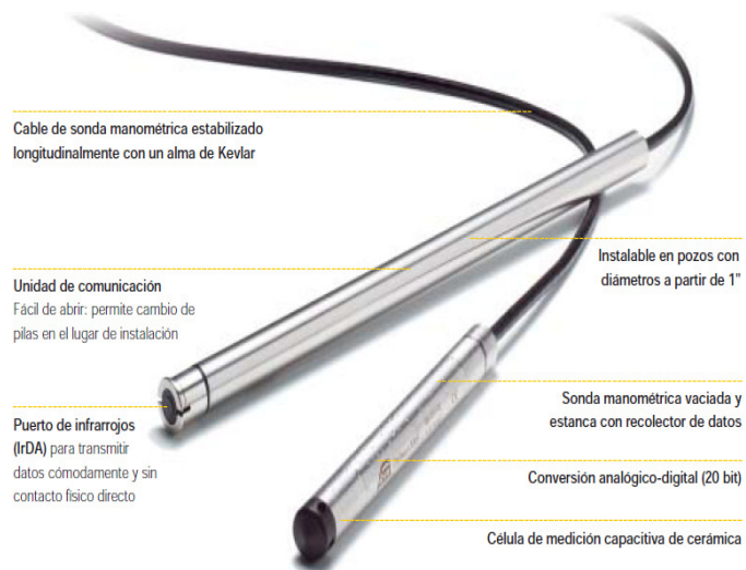
Foto No 6. Piezómetro automático Modelo Orpheus.
