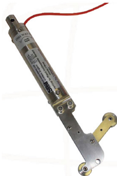
Foto No 2. Inclinómetro, modelo In Place Incliner (IPI). Cortesía de EYE.
