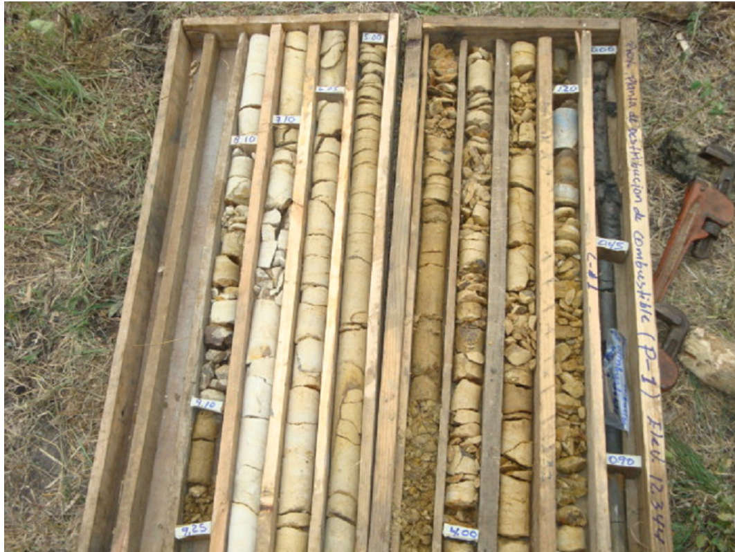
Foto No 3. Caja portatestigos de sondeo geotécnico en suelos en Miramar (León, Nicaragua). Foto T. Obando
