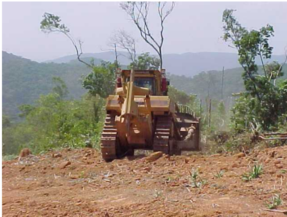
Foto 12 y 13. Remoción de la capa vegetal para la extracción del material de bauxita, a través de retroexcavadores.
