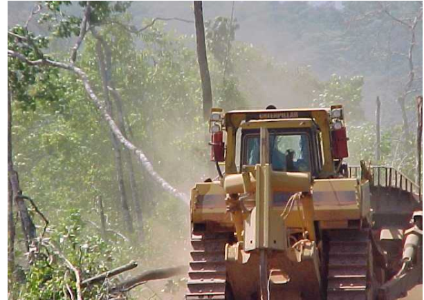
Foto 12 y 13. Remoción de la capa vegetal para la extracción del material de bauxita, a través de retroexcavadores.
