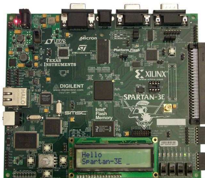
Figura 2.1 HW-SPAR3E-SK-US de la familia SPARTAN 3E de XILINX Este kit de desarrollo posee
