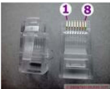
Numeración de pines en un conector RJ45 Macho
