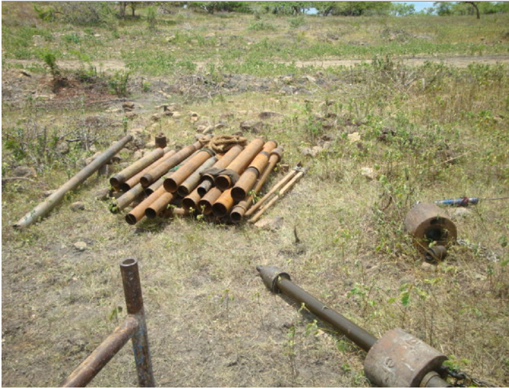
Foto No 2. Tomamuestras, puntazas y elementos del ensayo SPT en Miramar (León, Nicaragua). (Foto T. Ernesto Obando).
