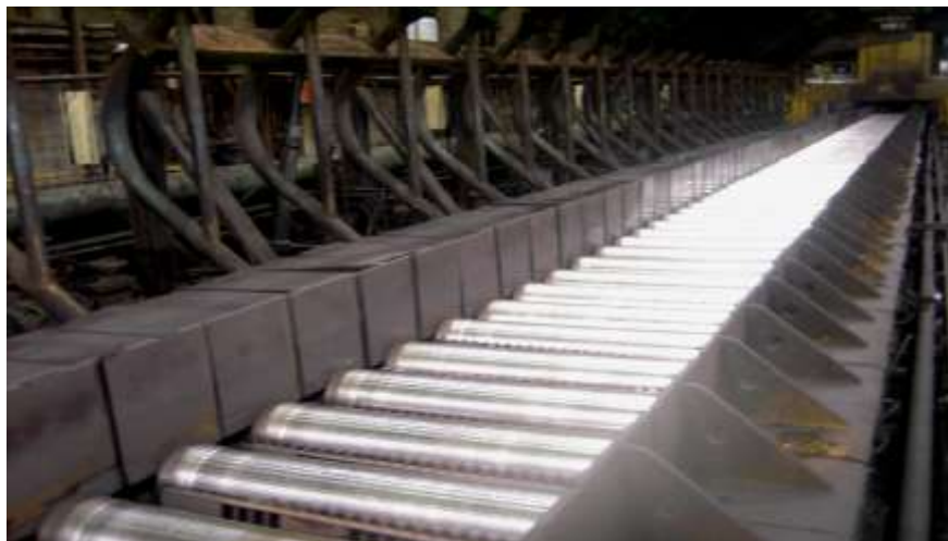
Vía Rodillo Salida del Bastidor 6
