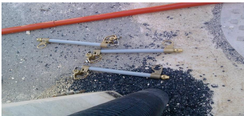
FIGURA 3 "Portafusibles y pértigos".
