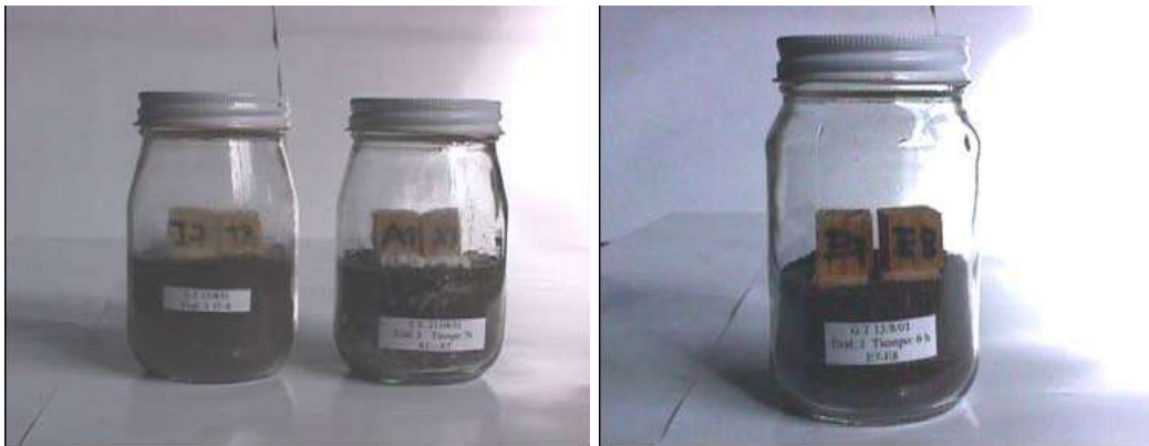
Figura 4. Prueba de Soil/Block . Frasco de vidrio conteniendo suelo, bloque de alimentación ya cubierta por el micelio del hongo y probetas, para la determinación de la perdida de peso ocasionada por los hongos de pudrición blanca ( Trametes versicolor ), izquierda, y pudrición marrón ( Gloeophyllum trabeum ) derecha
