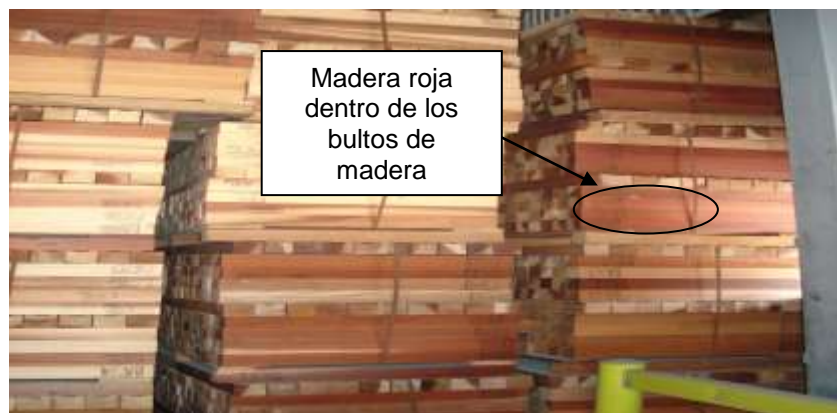
LISTONES CON DEFECTOS Y MADERA ROJA
