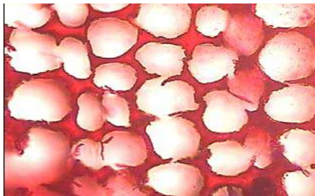
Figura 6.1. Madera de pino caribe sin tratamiento (testigo) atacada por el hongo de pudrición blanca T. versicolor . Se observa degradación de la pared celular, consecuente disminución del espesor de la pared celular y finalmente degradación de la lámina media.
