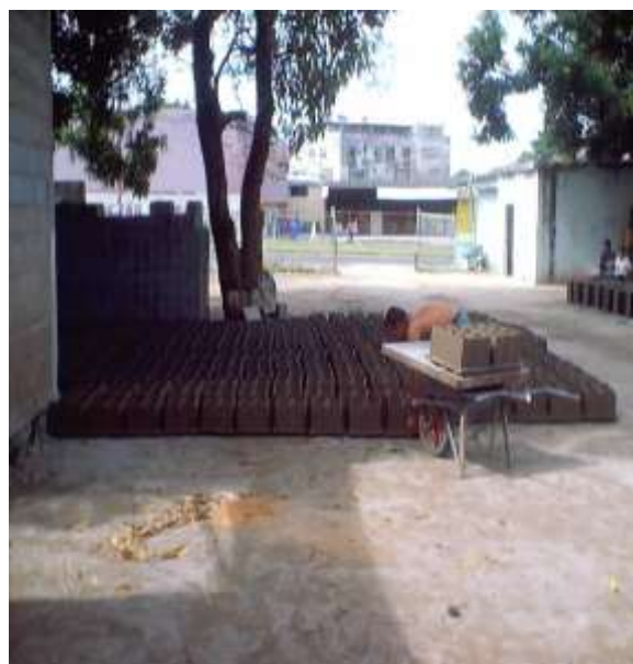
4) Colocación de las tablas en la zona de almacenamiento.
