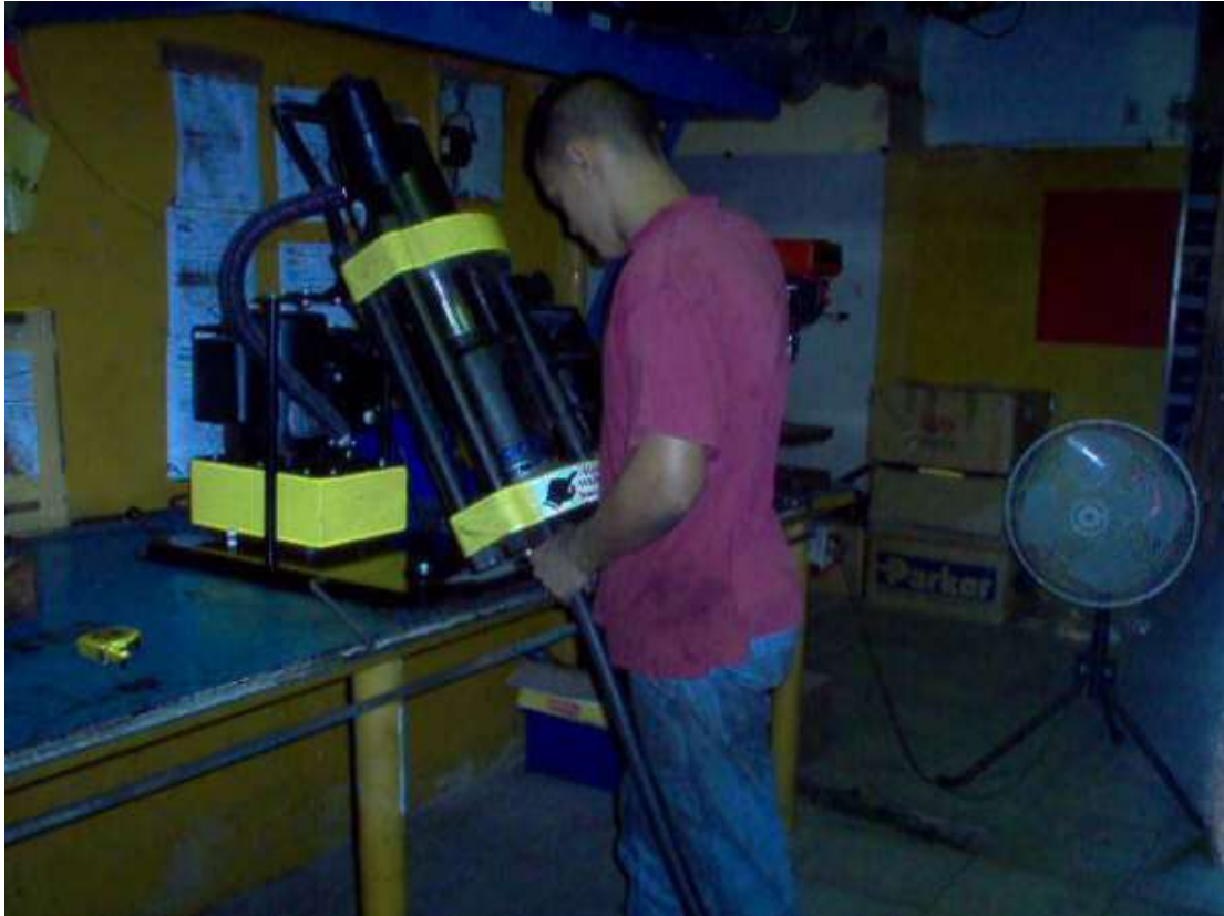
Anexo 8. Operación de prensado (prensadora hidráulica Parker D205)
