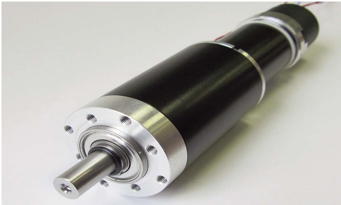
*Motoreductor brushless DC con reductora planetaria de 52 mm de diámetro, freno de seguridad y encoder. Junto con una electrónica de control formaría un servosistema. Entonces la unidad se denominaría servomotor.*
