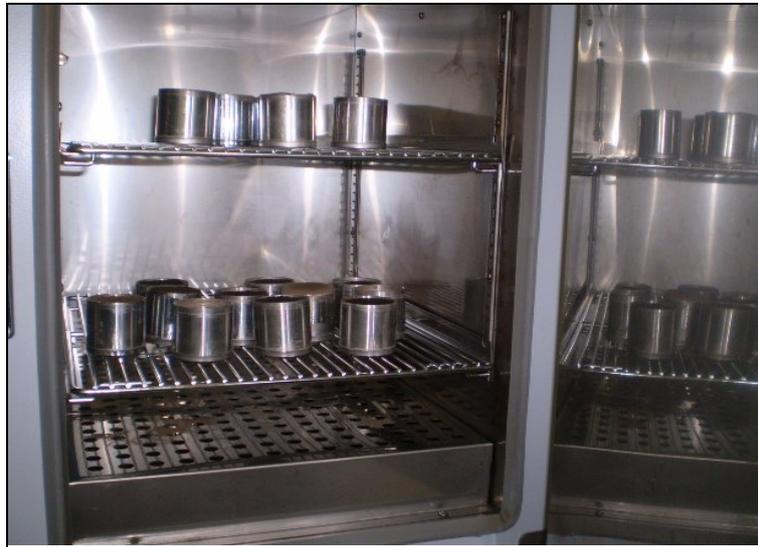
**Muestras colocadas en el horno luego de haber realizadó el proceso de permeabilidad para obtener el peso seco.**
