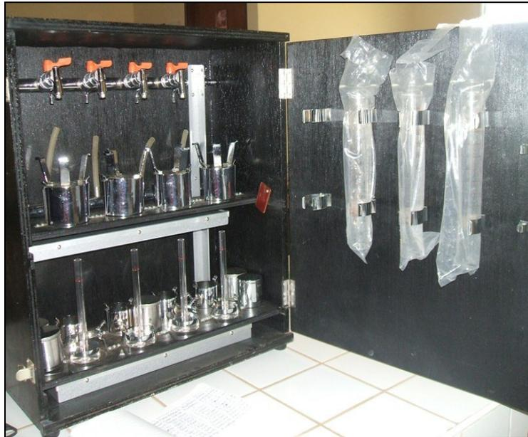
**DAIKI Modelo 4000 instrumento para medir el coeficiente de permeabilidad.**
