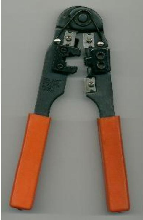
Alicates para Montar conector Macho RJ45
