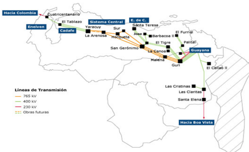
Figura 5. Sistema de Transmisión Troncal. CVG EDELCA. Sección de Inspección de Obras y/o Servicios.
