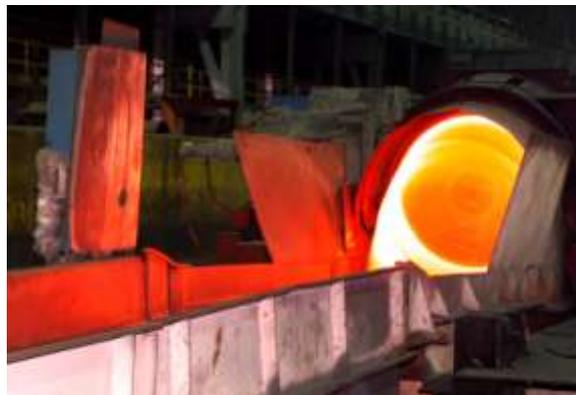
**Figura 7.** Formador de rollos, Tren de Alambrón.
