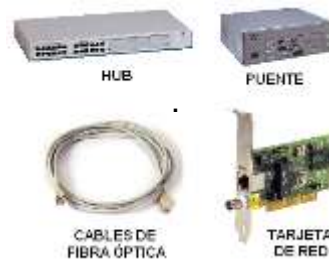
Figura 19 – Componentes necesarios para conectarse a una red
