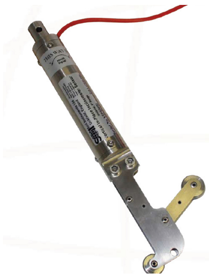
Foto No 1. Inclinómetro Modelo In Place Incliner (IPI). Cortesía EYE
