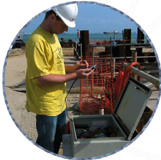
Foto No 4. Procesamiento de datos obtenidos de un inclinómetro
