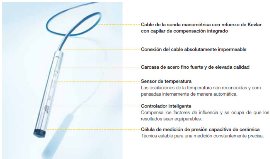
Foto No 5. Sensor del nivel de presión, modelo OTT PLS. Cortesía de Grobers, S.A.
