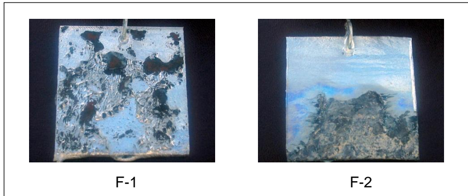
Figura 3.1.2 Defectos de la galvanización
