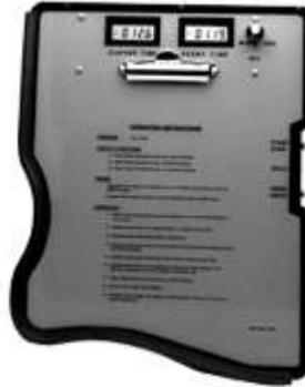
Fig. 3.6 Tablero con cronómetro electrónico.
