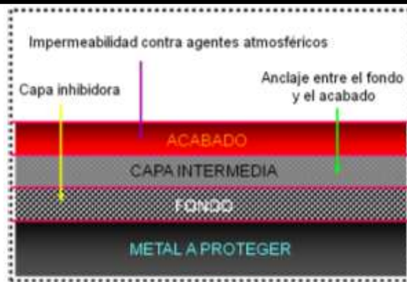
Figura N° 6: Sistema de recubrimientos.
