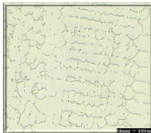
Figura 21. Microestructura original de un acero Centralloy® 4852 (ASTM A297 grado HP)
