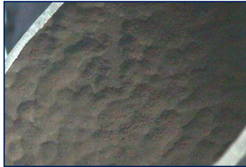
Figura 16. Morfología de daño de corrosión por metal dusting.
