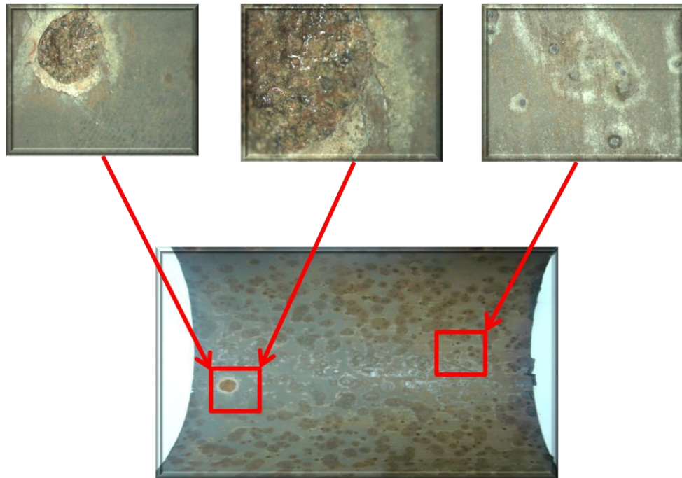
Figura 32. Morfología de degradación a gran aumento de la cara 1 del crossover (picadura).
