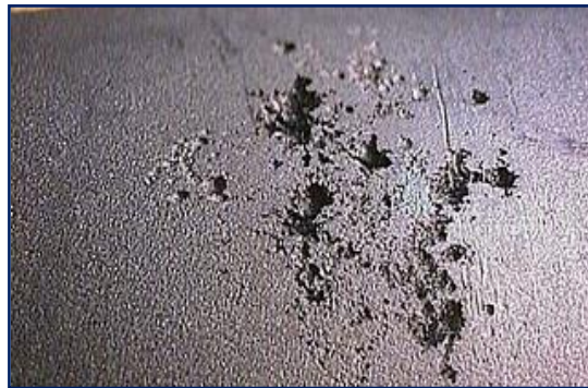
Figura 14. Morfología de daño por ataque localizado.
