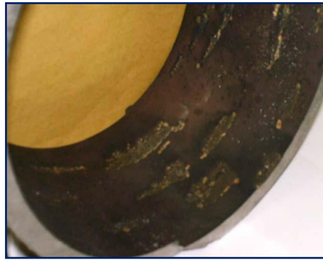
Figura 20. Morfología de daño de corrosión por sales fundidas.
