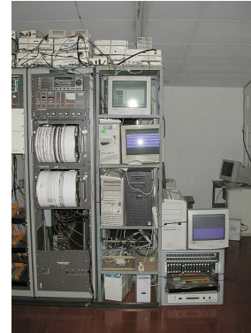
Ilust. 10 Sismógrafos Instrumentales y digitales. Cortesía de Ineter
