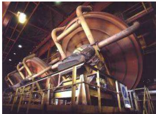
Figura 4: Imagen que muestra la Máquina peletizadora instalada en SIDOR Fuente: INTRANET SIDOR.
