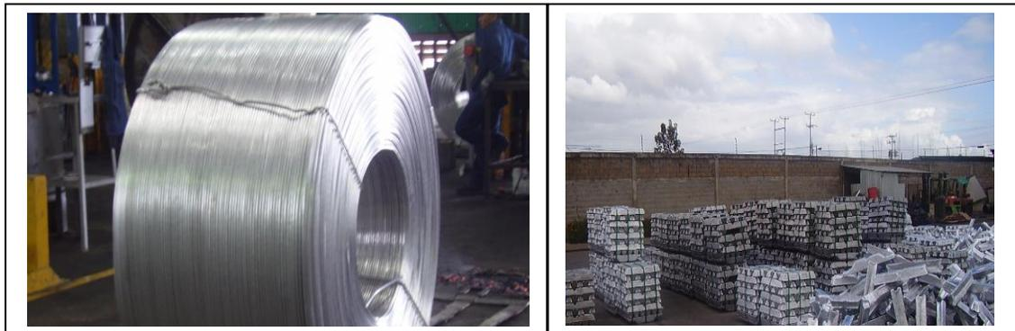
**Figura 2.3 Productos de la Empresa (a la izquierda Bobina de Alambrón. A la derecha Lingotes A1060, al fondo: organizados en bultos)**
