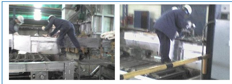
**Figura 5.13. Desnatado del aluminio contenido en el canal de transferencia**
