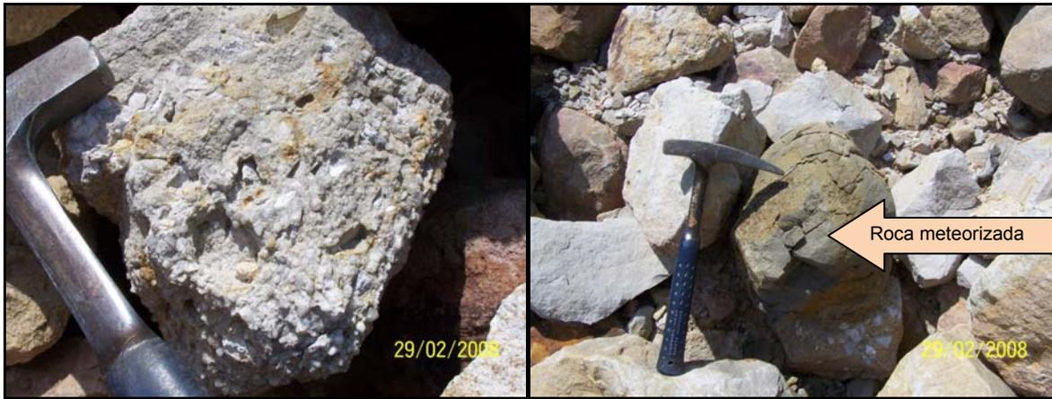
Figura 7. Muestras de rocas de la formación Mucujún (Areniscas lodolitas y conglomerados)
