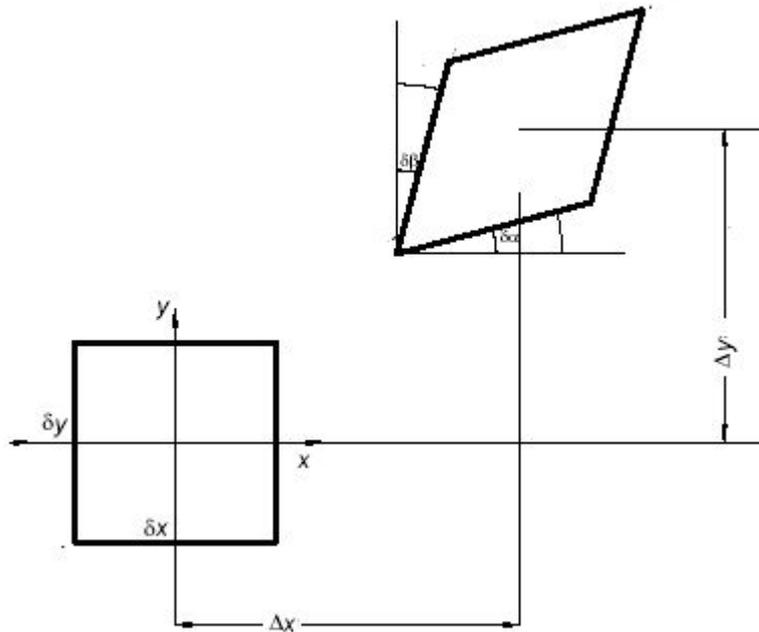
La *rotación* se define como la velocidad angular promedio de dos elementos que originalmente se encontraban ortogonales. Debe haber gradientes de campo de velocidad o esfuerzos cortantes para sostener la rotación durante el periodo  $dt$ . Teniendo en cuenta el elemento  $dx$ , y para ángulos pequeños, tenemos:
